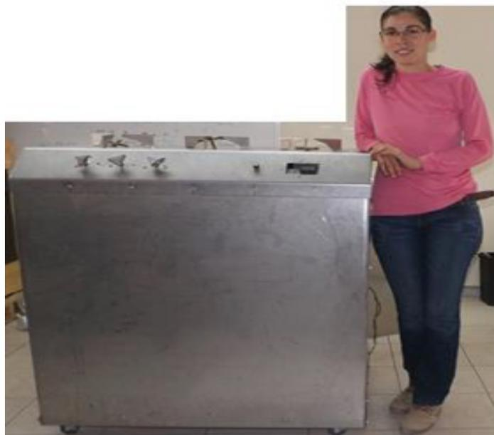
La evaluación de la estufa de hidrógeno consistió en obtener los parámetros de funcionamiento del electrolizador y del sistema de cocción, para determinar la eficiencia energética de la estufa de hidrógeno.
