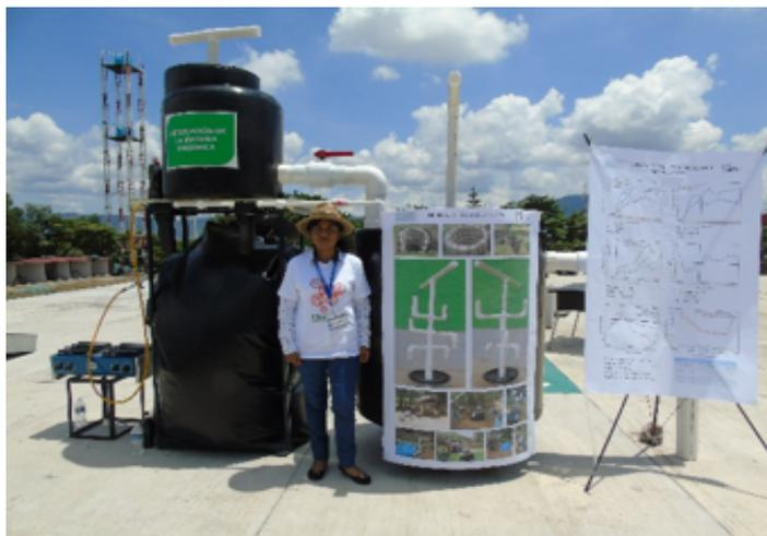
La producción de biogás se llevó a cabo en un sistema bioenergético, el cual es un conjunto de elementos interconectados entre sí, para la transformación de la materia orgánica, su principal componente es el biodigestor, donde se proporcionan las condiciones necesarias para llevar a cabo satisfactoriamente el proceso de digestión anaerobia, es decir, en ausencia de oxígeno y presencia de agua.
